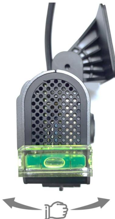
ブラケットスタッドを締付け、ドライブレコーダーの角度が簡単に変化しないようにし、水平器を外してドライブレコーダーの固定を完了します。
