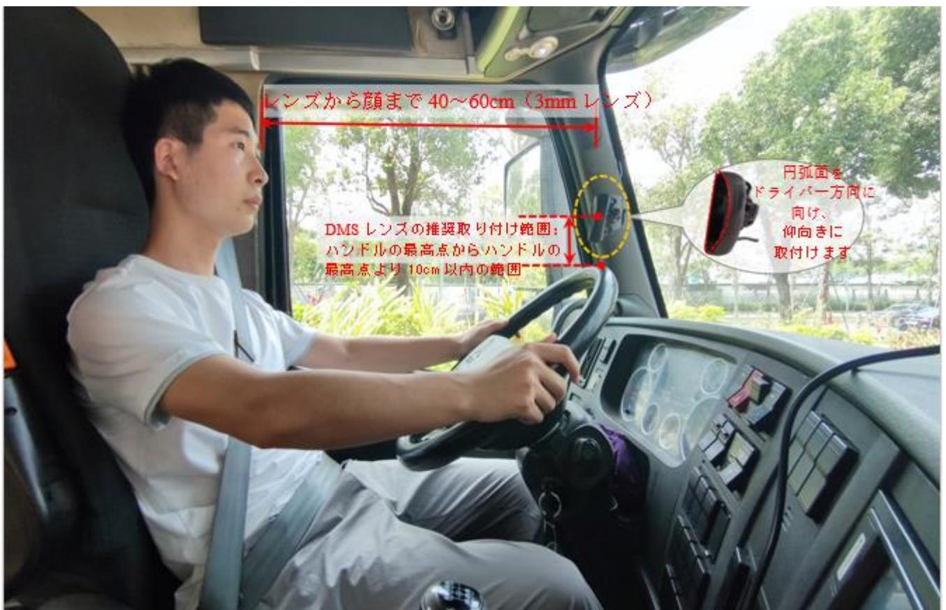
カメラの機種によって、カバー可能な「カメラとドライバーとの間の距離」が異なります。カバーできる範囲は以下の通りです：
