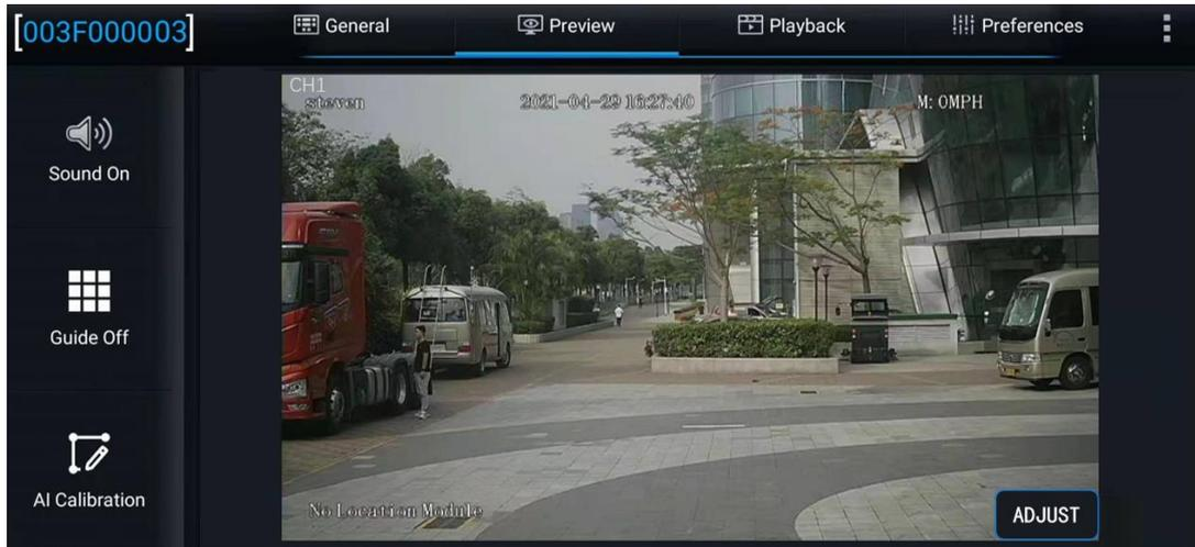
ライブプレビュー画面に入り、ADAS チャンネル画面をダブルクリックしてメインストリームに入ります。画面左下の「AI Calibration」ボタンをクリックして AI キャリブレーション選択画面に入り、ADAS キャリブレーションを行います
