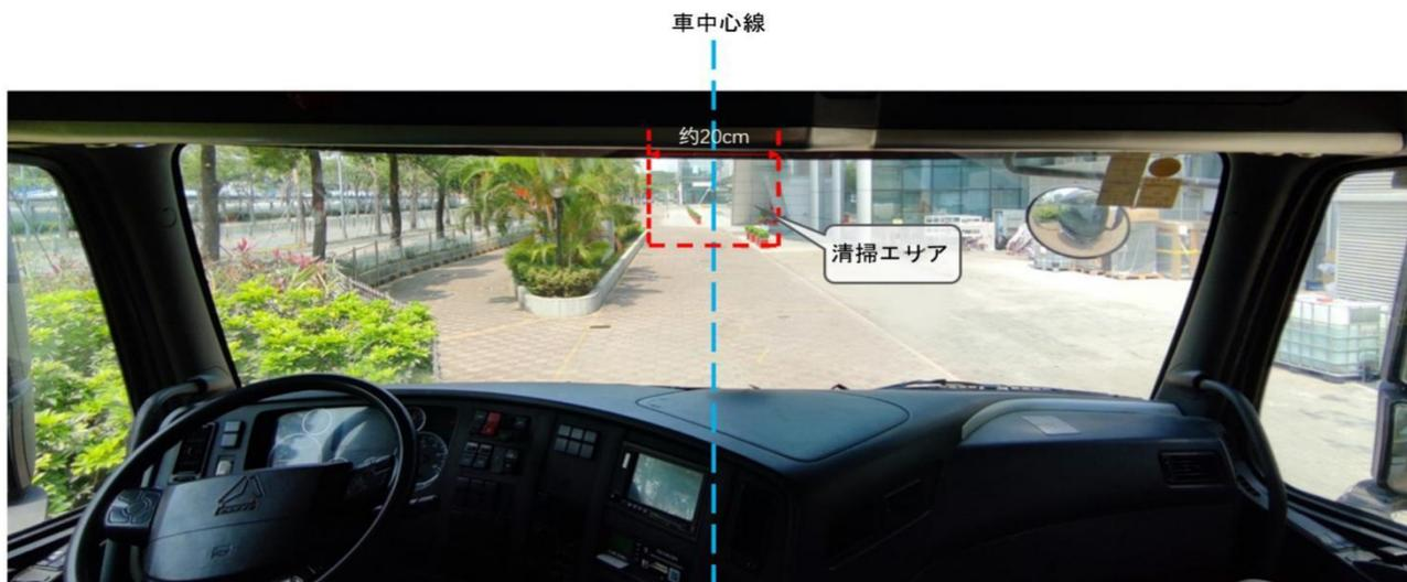
車が水平に駐車されていることを前提として、水平器を目標場所の上に水平に貼り付けてください（気泡が中心になるように水平器の傾斜角度を調整してください）。
