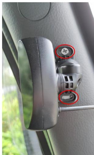
4.六角ネジで DMS カメラのジョイント部分を緩め、DMS の左右角度を調節してください。
